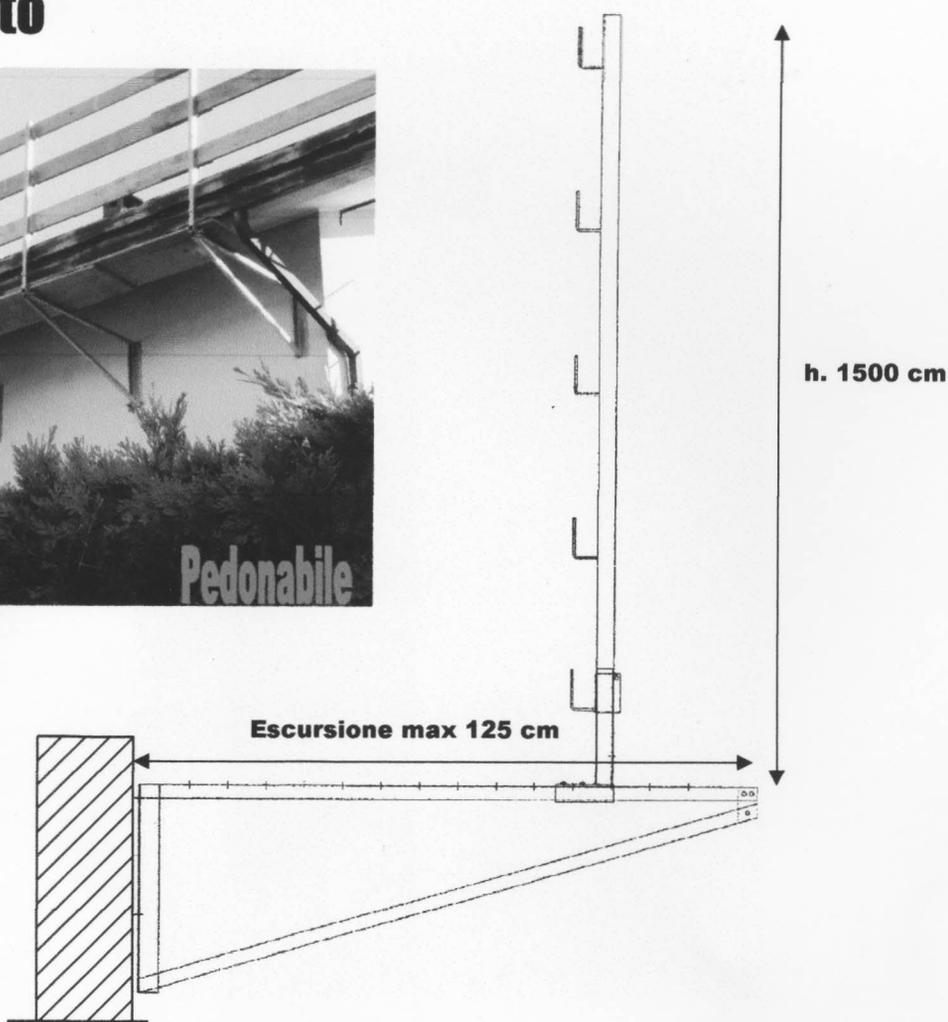
Dispositivo di protezione certificato in **classe C** secondo la norma UNI EN 13374/04.
