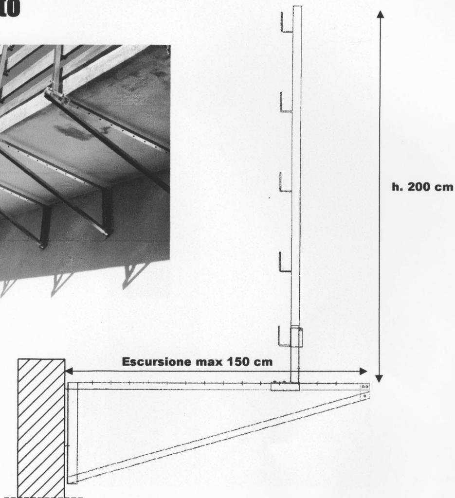
Dispositivo di protezione certificato in **classe B** secondo la norma UNI EN 13374/04.
