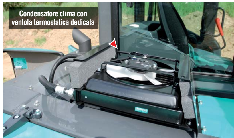
Supporti elastici bidirezionali e dilatazione termica agevole
