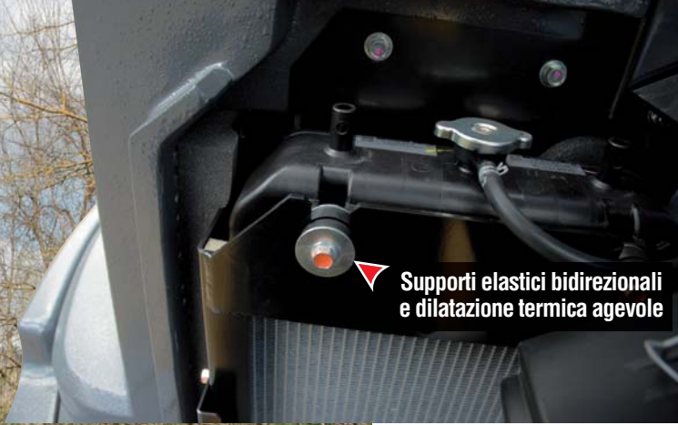
Condensatore clima con ventola termostatica dedicata
