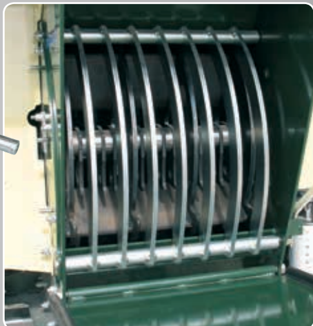
Vaglio di raffinazione fisso amovibile Fix removable refining screen Grille d'affinage fixe amovible Criba de refinación fija amovible Festes enforcerbares Sieb zur Verfeinerung Verstelbare zeef voor het verfijnen Неподвижный съемный рафинировочный грохот
