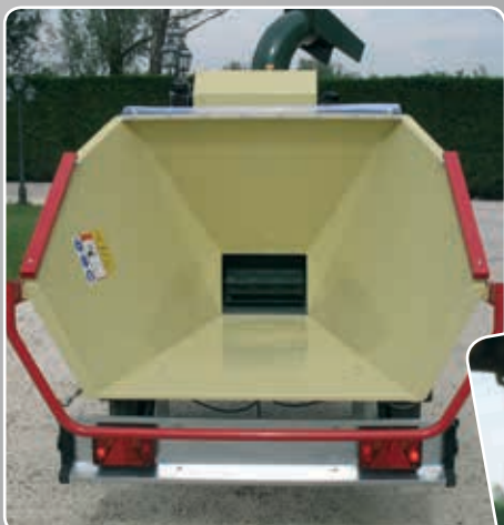
Tramoggia di carico, rullo trascinatore e particolare del maniglione di comando Feeding hopper, feeding roller and detail of the control handle Trémie de chargement, rouleau ameneur et détail de la poignée de commande Tolva de carga, rodillo transportador y detalle del manubrio de mando Zuführtrichter, Mithnehmerwalze und Detail des Steuerhandgriffs Aanvoertrechter, invoerrol en details voor de bedieningshendel Бункер загрузки, ролик втягивания и особая рукоятка управления
